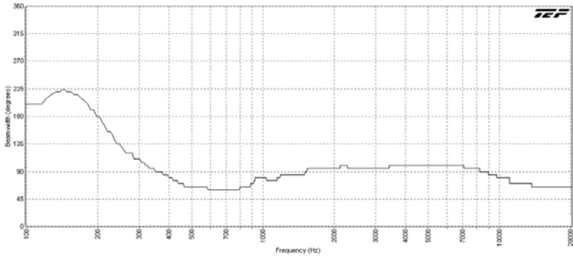
AH94-15-BSG Horizontal Beamwidth (-6dB)
